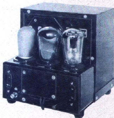
Rechts ein Kraftverstärker für eine Ausgangsleistung von 5 Watt. Werkphoto Philips.
